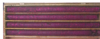
フェノールフタレイン散布後
